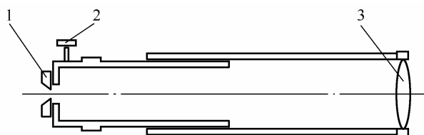
1. 狭缝；2. 调节缝宽螺钉；3. 凸透镜
