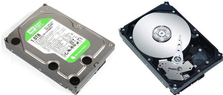
图 1-10 硬盘外观和内部结构
